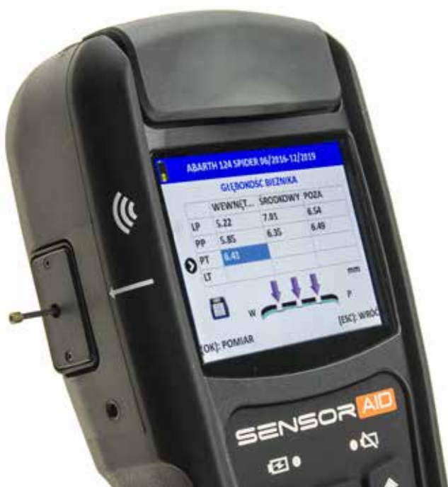
Miernik głębokości bieżnika opon wbudowany w programator
